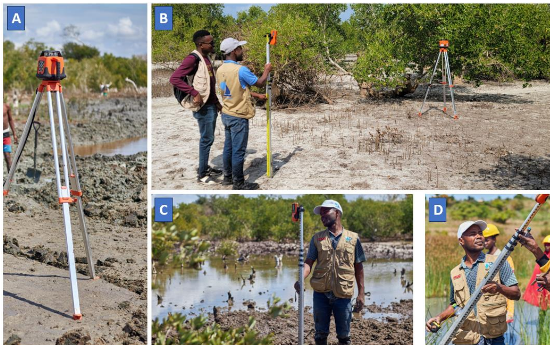
Figura 8: Medição do nível terreno (levantamento topográfico). Montagem e fixação do nível laser rotativo com auto nivelamento (A); Medição da altura ou nível do terreno pelo ajuste da altura da régua com o receptor do sinal do nível (B e C); Medição da altura da régua com uma fita métrica (D)
